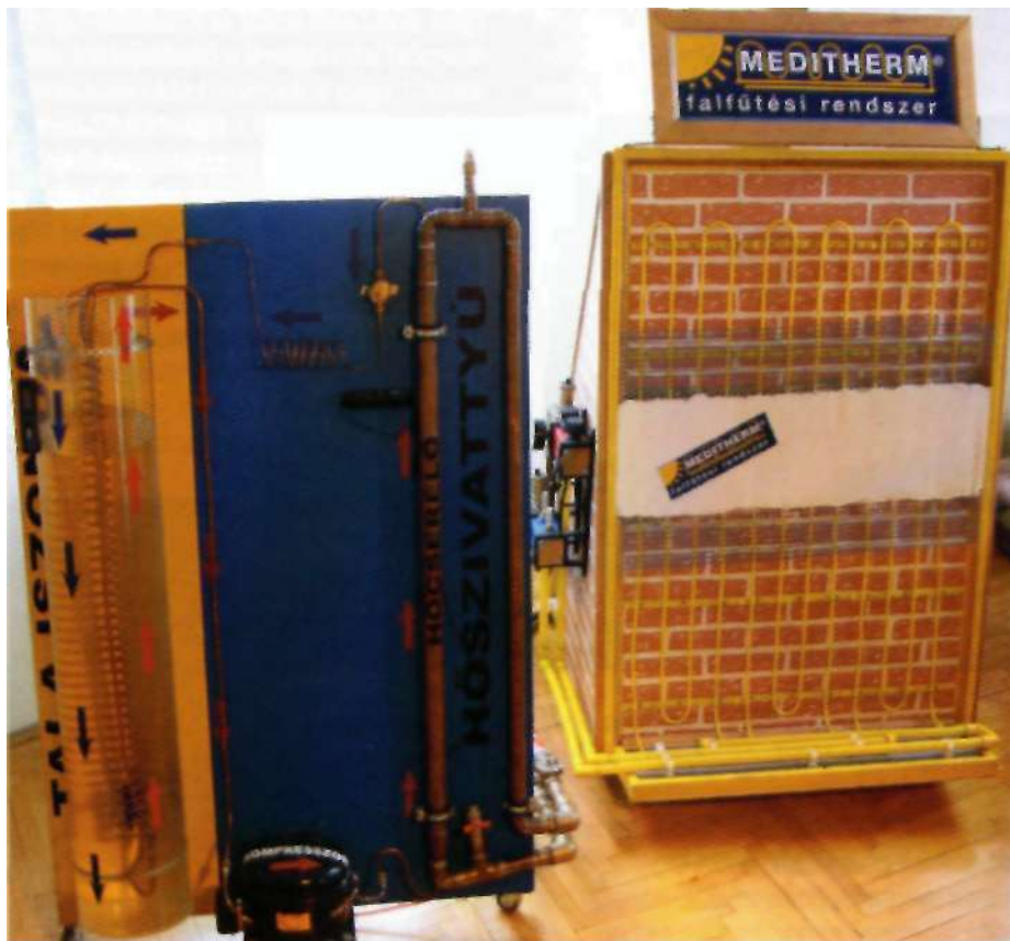
A hőszivattyú szemléltető vázlatja és a hozzá javasolt falfűtési rendszer
